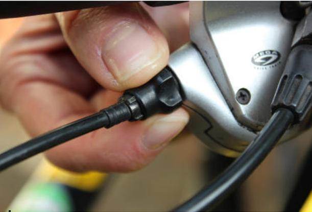
*Die Schraube für die Zugspannung am Schalthebel kann mit den Fingern gedreht werden*
